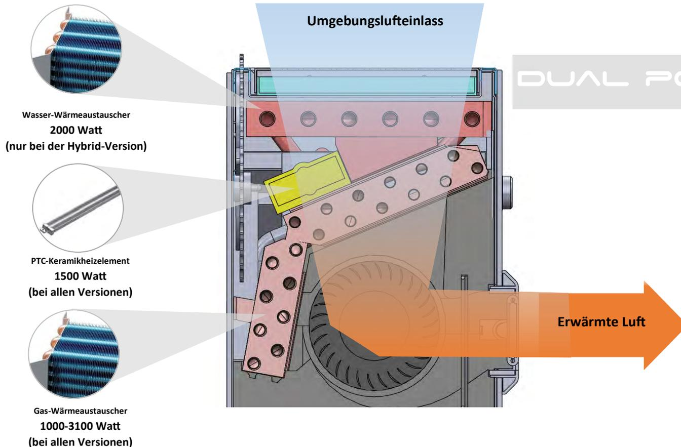
Um den für alle Luft-Luft-Wärmepumpen typischen Leistungsabfall bei sinkender Außentemperatur auszugleichen, sind die Produktlinien Silent - Silent Hybrid und Klima Puro mit Systemen ausgestattet, die die Wärmeleistung auch bei extrem kalten Temperaturen verbessern .
