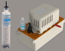
Patentierter\* Neuentwicklung: die Kartusche pH Safe wird direkt auf die Pumpe Si-82 montiert und kann innerhalb eines Jahres bis zu 800 l Kondensat mit einem pH-Wert von 3,0 neutralisieren.
