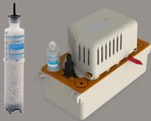
Patentierter\* Neuentwicklung: die Kartusche pH Safe wird direkt auf die Pumpe Si-82 montiert und kann innerhalb eines Jahres bis zu 800 l Kondensat mit einem pH-Wert von 3,0 neutralisieren.
